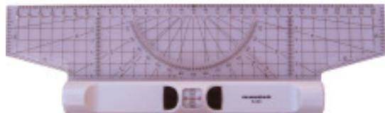
Parallel-Roll-Lineale Roll-Lineal mit weissem Kunststoff-Gehäuse und darin eingeschraubter Walze. Auf dem im Gehäuse integriertem, transparenten Plexiglas-Lineal-Körper sind eine 30 cm lange Teilung, ein Winkelmaß, Parallel-Linien und Tuschenoppen angebracht. • Bedienung mit einer Hand möglich • die Walze bewirkt eine zuverlässige Führung
